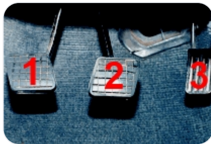
1 – съединител 2 – спирачка 3 – газ
